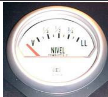
(con lámpara y tablero. 12volts 33-240 Ohms. Diámetro aro 67mm)
